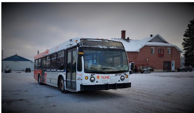
Doté d'une capacité de 42 places, le nouvel autobus urbain offre aux passagers un meilleur confort. Il est muni d'un plancher bas (à une seule marche) facilitant l'entrée à bord de gens moins mobiles, plus âgés, transportant des poussettes ou de passagers en fauteuil roulant dont l'autonomie permet de voyager avec le transport collectif.
